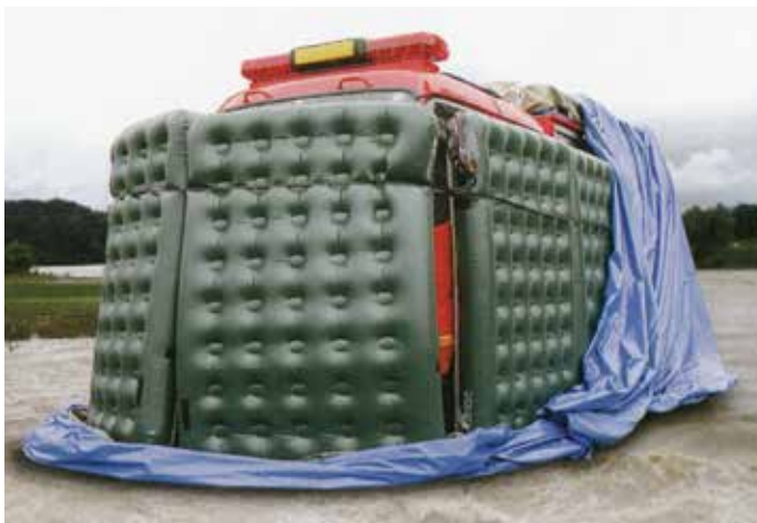
車両を衝撃吸収エアーマットで囲んだ状態
